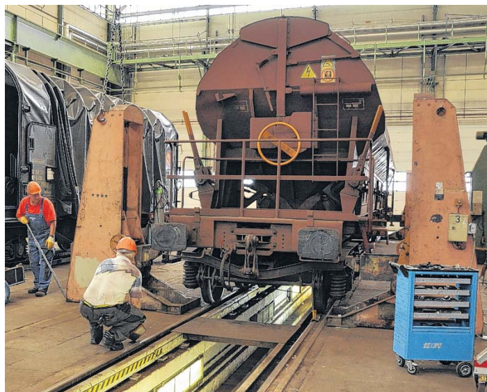
Zwei Mitarbeiter bocken einen Güterwagen auf. Nach einer bestimmten Laufleistung werden die Radsätze und Drehgestelle auf Verschleiß überprüft und notfalls nachgebessert oder ausgetauscht. Etwa 100 Daten pro Radsatz werden dabei papierlos digital übermittelt und ausgewertet.
