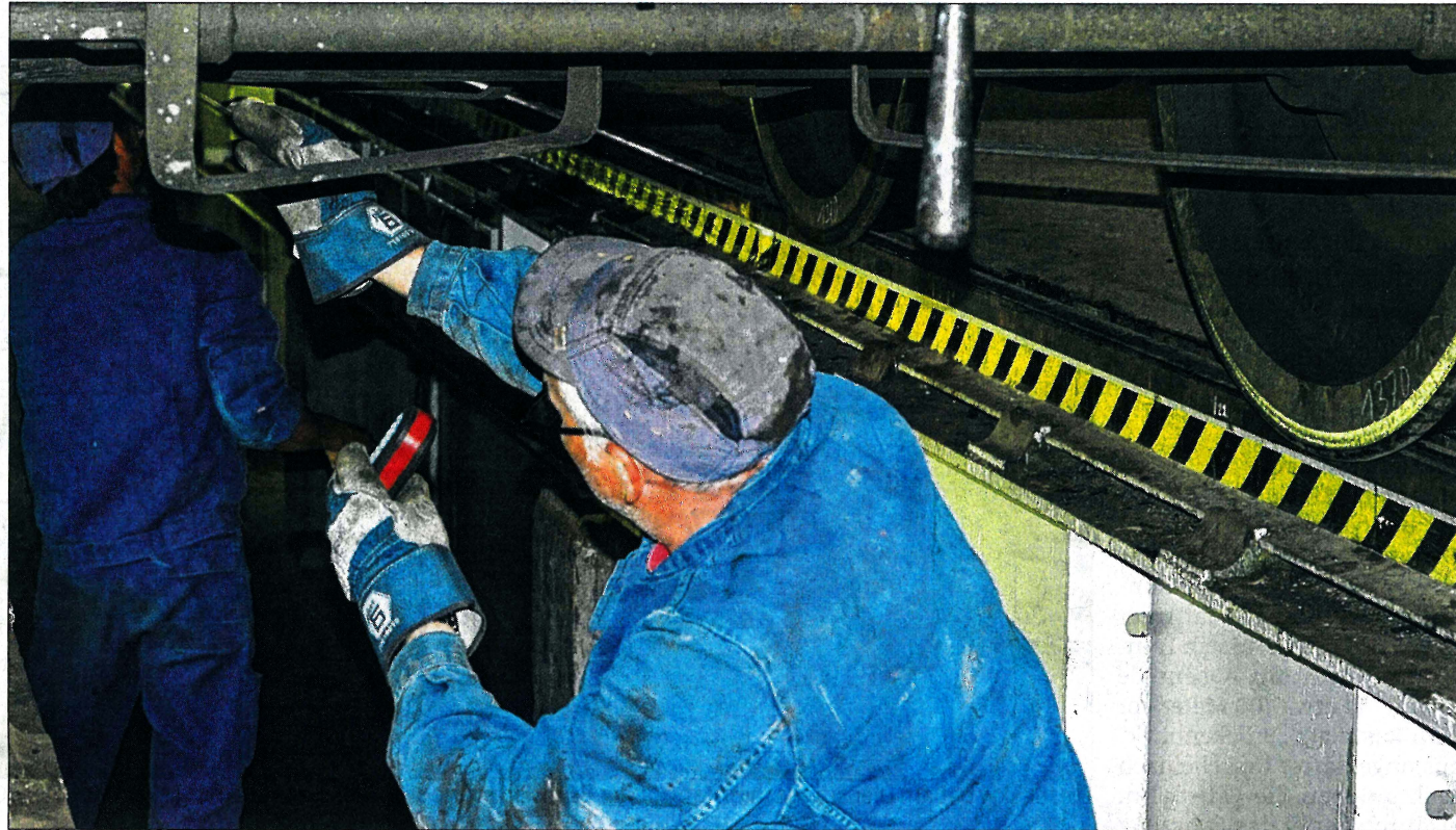
Mit einer Lampe prüft Fred Krüsemeyer Radsatzwellen eines Waggons. Er ist seit vier Jahren Mitarbeiter des FEW Blankenburg, das sich auf bahnspezifische Tätigkeiten spezialisiert hat.
