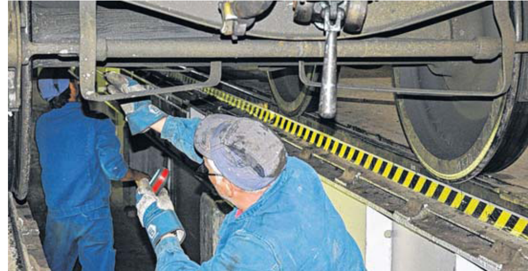
Mit einer Lampe prüft Fred Krüsemer Radsatzwellen eines Waggons. Er ist seit vier Jahren Mitarbeiter des FEW Blankenburg, das sich auf bahnspezifische Tätigkeiten spezialisiert hat. Foto: Sandra Reulecke
