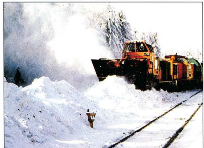
Hochleistungsschneefräse (HSF) 80 bei einem Demonstrationseinsatz.
