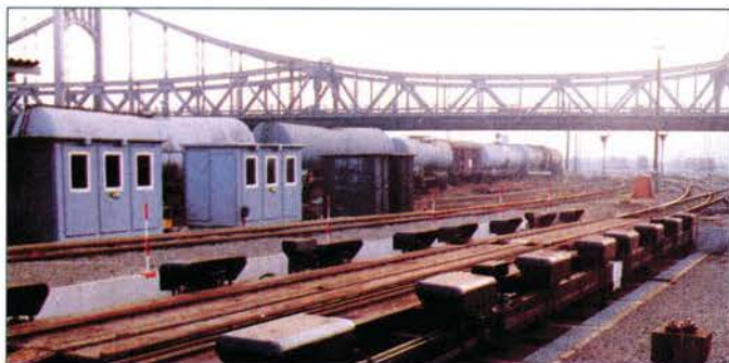
Balkengleisbremsen und Hydraulikstationen auf dem Rangierbahnhof Halle (Saale) 1992.
