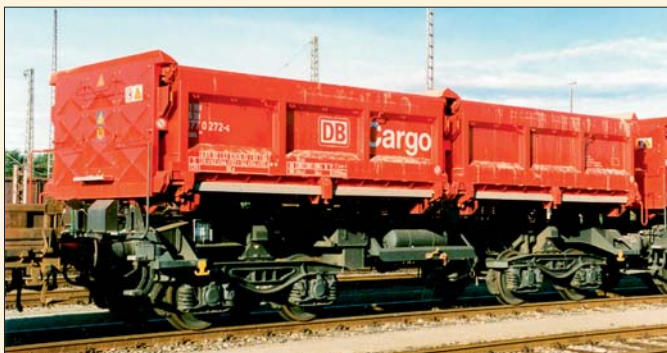
Die modernste Ausführung der DB-Zweiseitenkipper stellen die gänzlich in Verkehrsrot ausgelieferten Fans 128 dar (Mai 1997, München Nord Rbf).
