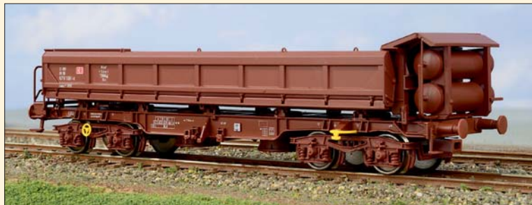
Von Piko kommt die H0-Nachbildung dieses Wagentyps. Die Mulde ist kippbar, die Seitenwände sind beweglich.
