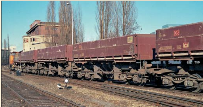
Deutlich vom Baueinsatz gezeichnet waren diese Schüttgutwagen der Bauart Fas 126 im Jahr 1996 in Berlin-Priesterweg.
